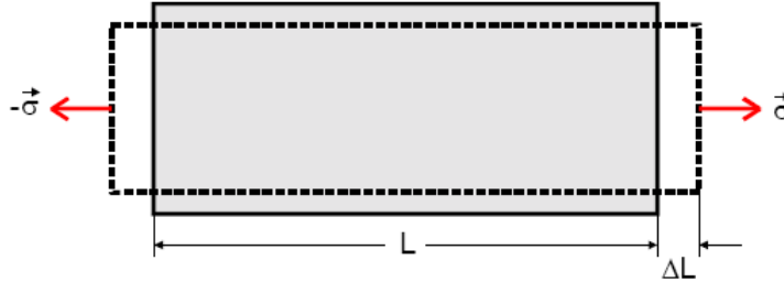
Abbildung 1: Dehnung einer stabförmigen Probe unter dem Einfluss einer Normalspannung
